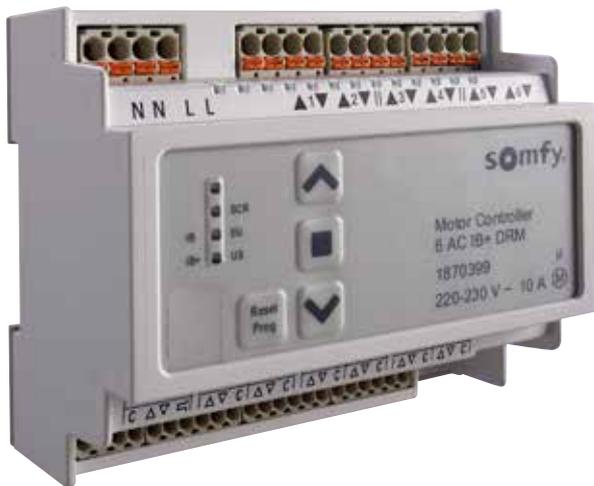
Motorsteuergerät für Schaltschrankmontage (DRM) zur Ansteuerung von Raffstoren, textilem Sonnenschutz, Rollläden und Fensteröffnern. Zur individuellen Steuerung von 6 x 230 V AC Antrieben über lokale Taster und über die animeo IB/IB+ Steuerleitungstechnologie. Kompatibel mit allen animeo IB/IB+ Zentralen.
