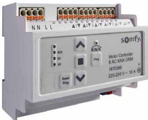
Motorsteuergerät für Schaltschrankmontage (DRM) zur Ansteuerung von Raffstoren, textilem Sonnenschutz, Rollläden und Fensteröffnern. Zur individuellen Steuerung von 6 x 230 V AC Antrieben über die KNX Steuerleitungstechnologie. Kompatibel mit dem Somfy TaHoma KNX Konfigurator und animeo KNX Zentralen.
