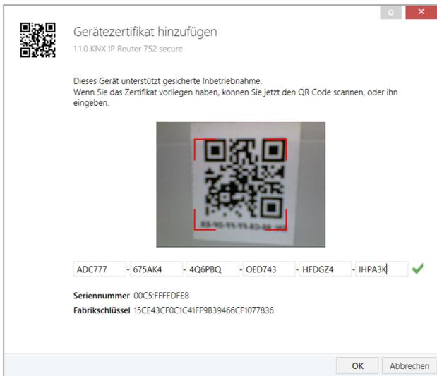
Das Zertifikat ist als Text auf dem Gerät aufgedruckt. Es kann auch bequem über eine Webcam vom aufgedruckten QR-Code abgescannt werden.
