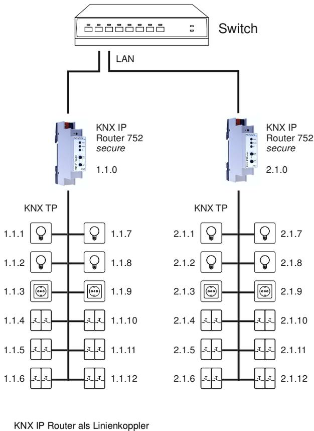
Die Vergabe der physikalischen Adresse des KNX IP Router 752 *secure* entscheidet, ob das Gerät als Linien- oder als Bereichskoppler arbeitet. Entspricht die physikalische Adresse der Form  $x.y.0$  ( $x, y: 1..15$ ), funktioniert der Router als Linienkoppler. Hat die physikalische Adresse die Form  $x.0.0$  ( $x: 1..15$ ), handelt es sich um einen Bereichskoppler.
