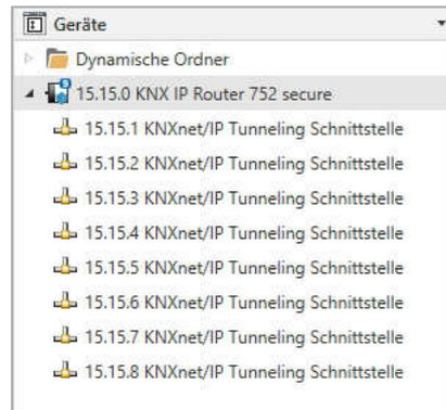
Um die einzelnen Adressen zu ändern, ist der entsprechende Eintrag in der Liste zu markieren und im Textfeld die gewünschte Adresse einzugeben. Sollte der Rahmen des Textfeldes, nach Eingabe, seine Farbe auf Rot wechseln, weist dies darauf hin, dass die eingegebene Adresse bereits verwendet wird.
