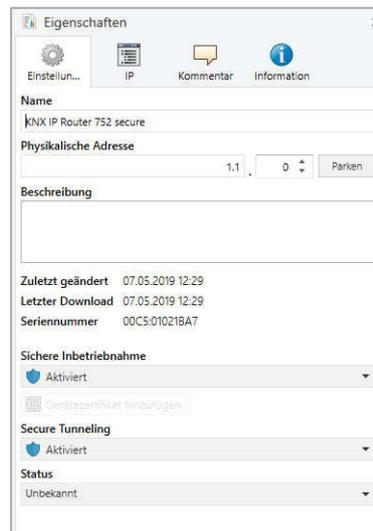
Wenn Secure Tunneling aktiviert ist, wird automatisch ein Passwort für jeden Tunnel vergeben. Dieses Passwort wird unter Menüpunkt „Einstellungen“ angezeigt, wenn ein Tunnel ausgewählt ist.
