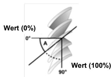
Mit diesem Parameter wird die Zwischenposition 1 „Lamelle“ konfiguriert. Der Sollwert in % bezieht sich auf die konfigurierten vollständigen Lamellenwendungen der entsprechenden Jalousie auf der Menüindexkarte Motor 1...4/Motor 1–4.
