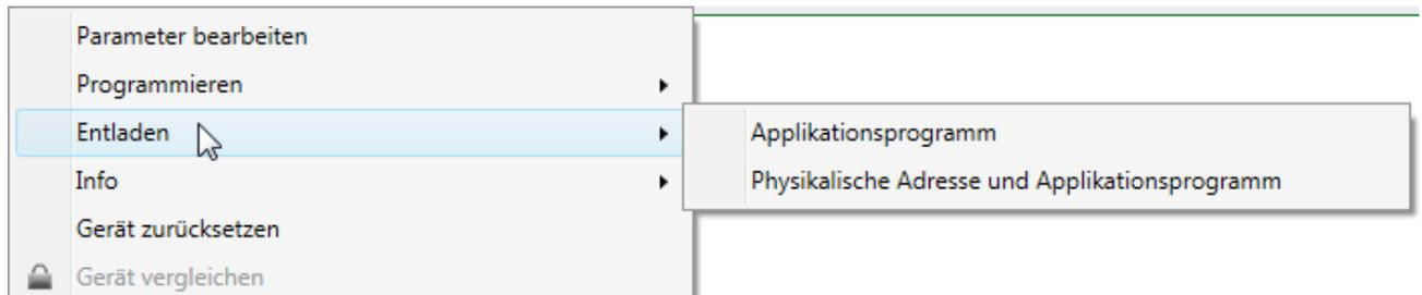
Wenn das Gerät mit der ETS-Software programmiert ist, kann die Zurücksetzung in den Auslieferungszustand nicht mehr über die Reset/Prog-Taste erfolgen. Mit der Funktion „Entladen“ in der ETS-Software lassen sich alle Einstellungen des Geräts in den Auslieferungszustand zurücksetzen. Dann ist die Reset/Prog-Taste wieder frei verwendbar.
