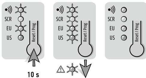
Die Einstellungen, die über die Reset/Prog-Taste vorgenommen wurden, können wieder in den Auslieferungszustand zurückgesetzt werden, indem die Reset/Prog-Taste 10 Sekunden lang gehalten wird.
