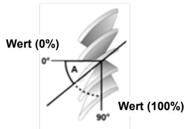
Mit diesem Parameter wird die Zwischenposition 2 „Lamelle“ konfiguriert. Der Sollwert in % bezieht sich auf die konfigurierten vollständigen Lamellenwendungen der entsprechenden Jalousie auf der Menüindexkarte Motor 1...4/Motor 1–4.
